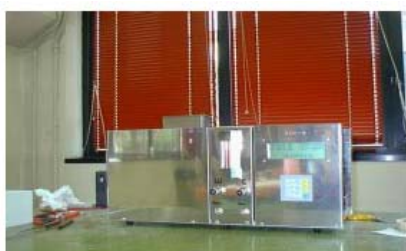
Foto 8 - Sistema di controllo fumi Delta T
